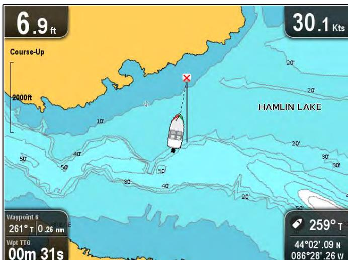
Durante la navegación activa, en el modo **Rumbo arriba**, la aplicación cartográfica muestra el waypoint de destino actual del barco directamente arriba. Al cambiar el COG, el símbolo del barco se mueve en consecuencia. Si hace un cambio de rumbo, la imagen se reseteará para mostrar el nuevo rumbo hacia arriba.
