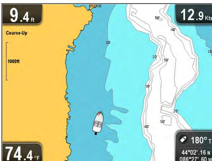
Con la **Posición del barco** en Desplazamiento el símbolo del barco se desplaza del centro con el fin de que delante tenga visible más área cartografiada.
